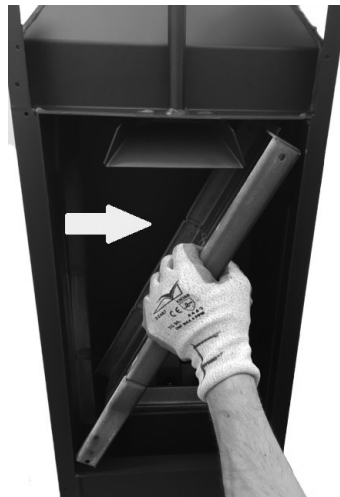
Fig. 42 - Fjernelse af venstre røggassystem
