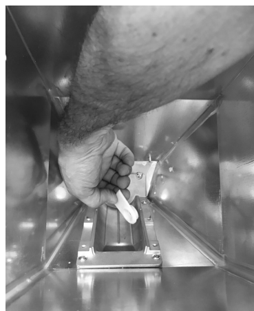
Fig. 40 - Fjernelse af leje
