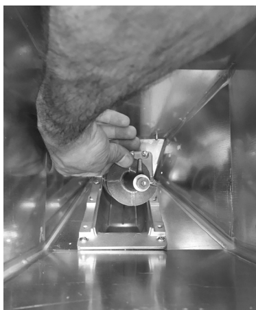
Fig. 39 - Udtagning af spiralen
